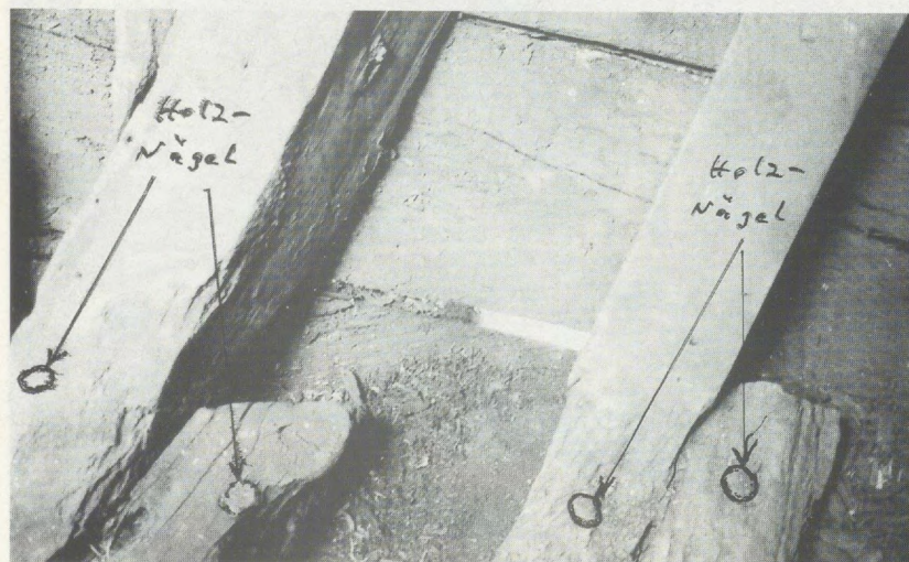
Der Rumpf des Schiffes ist während seines vierzehnjährigen Liegens an Land inzwischen völlig ausgetrocknet. Das führte dazu, daß sich z. T. die Holznägel und ihre Verteilung lösten und die Nähte sich öffneten. Während ersteres zu einer Schwächung des Gesamtverbandes beiträgt, also negativ ist, bieten die offenen Nähte eine willkommene Ventilation. (Foto: M. Götsche, 17. 6. 1992)
