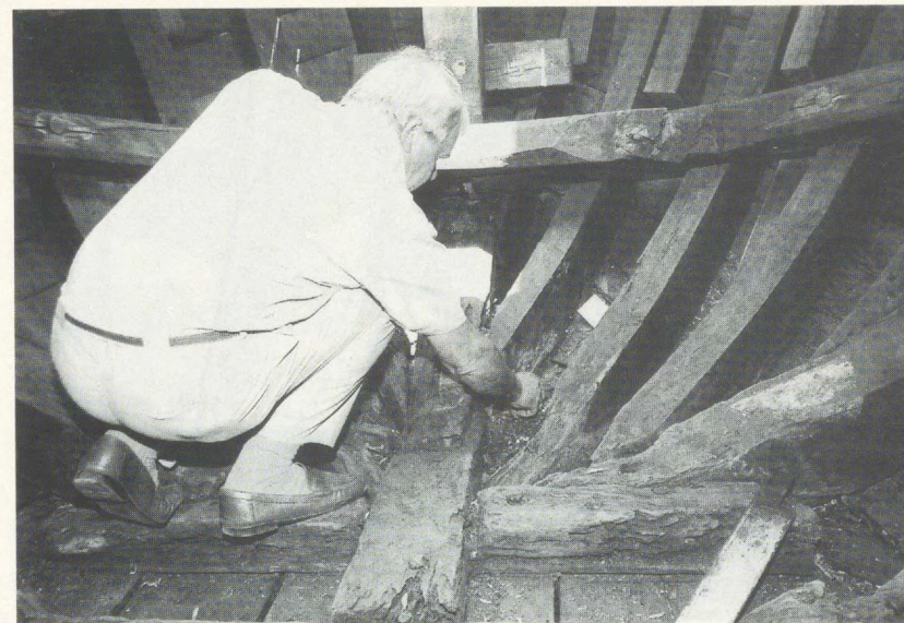
Besonders im Bodenbereich des Vorschiffs hat sich schon früher viel Unrat angesammelt. Hier wurde selten oder nie aufgeklart. Kam noch Feuchtigkeit hinzu, bildeten sich Faulnester. Der Zustand der dortigen Innenhölzer ist entsprechend. Hier muß schnell und gründlich gereinigt und konserviert werden.
