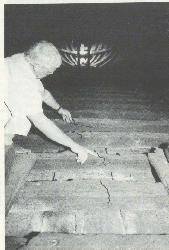
Besonders im Bodenbereich des Vorschiffs hat sich schon früher viel Unrat angesammelt. Hier wurde selten oder nie aufgeklart. Kam noch Feuchtigkeit hinzu, bildeten sich Faulnester. Der Zustand der dortigen Innenhölzer ist entsprechend. Hier muß schnell und gründlich gereinigt und konserviert werden.
