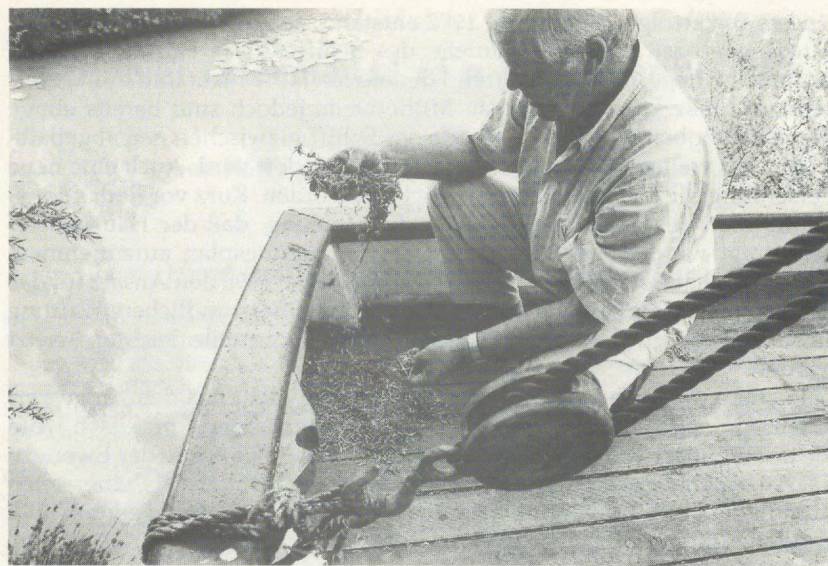
Ein Dauerproblem an „Hermanns“ Standort ist der Laub- und Blütenabwurf der umstehenden hohen Weidenbäume. Zusammen mit Regenwasser bilden sich Faulnester auf den Decks. Diese erst zehnjährigen Gehölze werden mit zunehmendem Alter das Problem noch vergrößern. Sie sollten entfernt werden. (Foto: M. Götsche, 17. 6. 1992)
