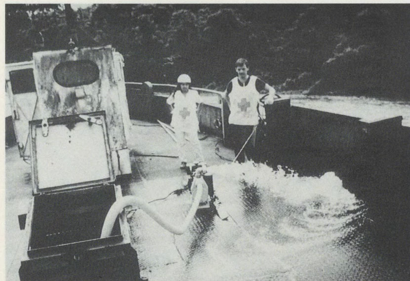
Vorbereitungen für die Bergung der „GRÖPELN“ im November 1986. Unter dem Schutz des Roten Kreuzes wird eingedrungenes Wasser aus dem Schiff abgepumpt. (Foto: Slg. Claus Ferner, Bremen)
