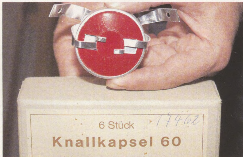
Knallkapseln sind ein Relikt aus der Dampflokezeit. Sollte der Lokführer in seinem lauten Gefährt vor Schäden am Gleis gewarnt werden, wurden sie in 30 m Abstand auf die Schienen geklemmt und explodierten beim Überfahren lautstark. (Foto: Björn Marnau)
