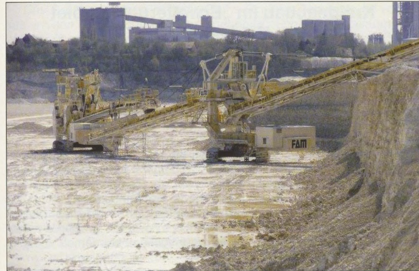
Große Förderbandmaschinen befördern die Kreide aus der Grube zur Schlammerei. (Fotos: Axel Przybylski)
