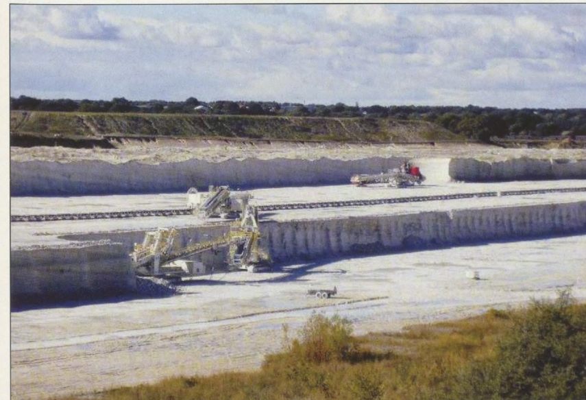
Im „neuen“ Teil der Grube Heidestraße, zwei Bagger „fressen“ sich durch die Kreide. (Foto: Axel Przybylski)
