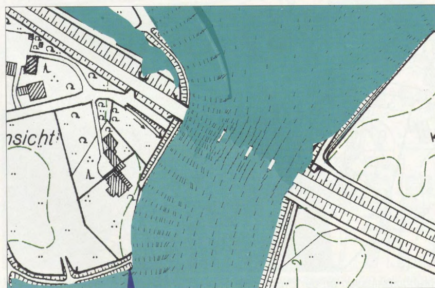
Wasserspiegelhöhen und Strömungsbild an der B206; oben: IST-Zustand, unten: nach Wegnahme des linkseitigen Brückenaufagers
